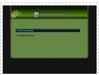
Выберите Common Interface из главного меню и нажмите кнопку OK. Выберите слот с установленным в него модулем и нажмите OK. Далее Вы можете просматривать и изменять параметры CAM модулей и вставленных в них смарт-карт. Обратите внимание на инструкцию по использованию CAM модулей и смарт-карт.
