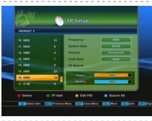
Информация о параметрах приёма представлена в журналах для спутникового телевидения. Вы можете использовать это окно для поиска специальных каналов, которые могут быть найдены только при помощи введения дополнительной информации и выполнения установок. Вы можете настроить Частоту ретранслятора, Символьную скорость потока, Поляризацию, Демодуляцию, Параметр исправления ошибок (FEC), Пилот, используя
